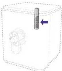
Filtro cerámico en depósito
